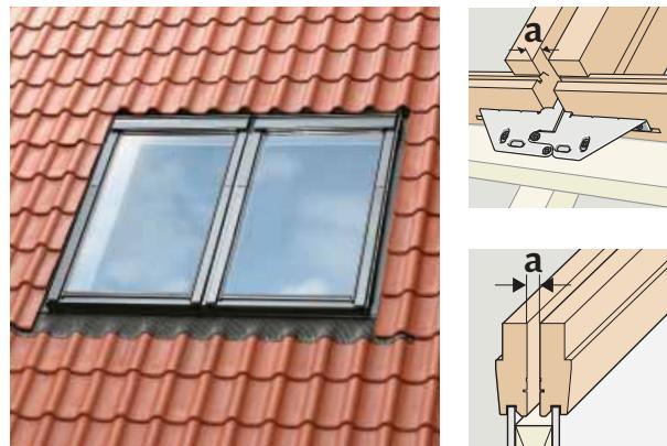
Высоко расположенный промежуточный дренажный желоб дает возможность устанавливать окна близко друг к другу. Между окнами следует предусмотреть опорную балку.
