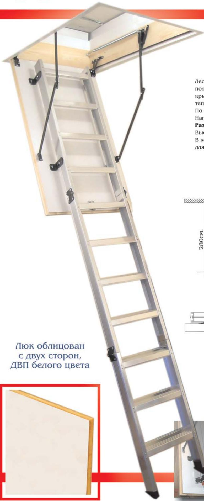
Лестница складная трехсекционная. Рабочая поверхность полностью выполнена из алюминия. Термоизоляционная крышка типа "сэндвич" толщиной 47мм, имеет усиленную теплозащиту, облицована с двух сторон ДВП белого цвета. По контуру короба имеется уплотнитель, высота короба 170мм. Нагрузка на ступень лестницы 150 кг.
